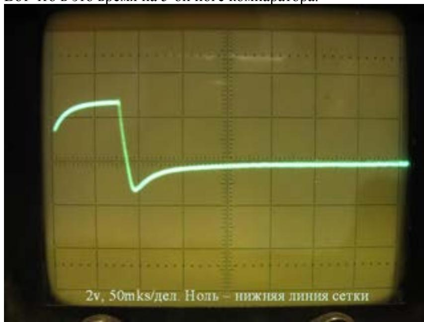
(Импульс накачки завален, измерительный импульс сильно сглажен интегрирующей цепью. Напряжение во время его действия просаживается до уровня прим. 4.5 вольта.)
