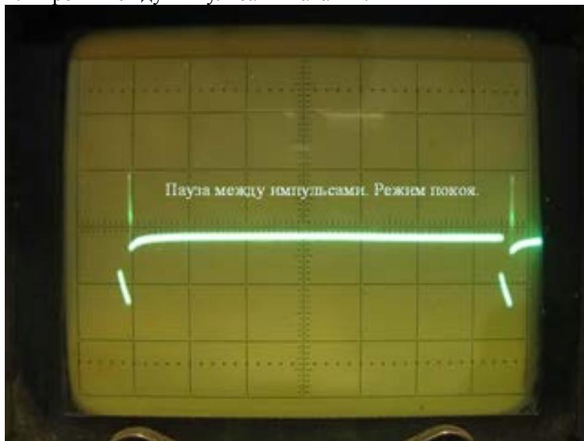
В это время действуют режимы «покоя» схемы, конденсаторы С5 и С6 заряжаются до некого значения за счёт тока, текущего через R12 и R13. Как видно из схемы, на конденсаторе С5 напряжение выше, чем на С6, на выходе компаратора «0».
